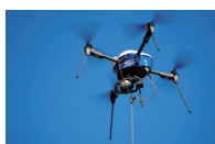
有線ドローン「エアロボオンエア」 エアロセンス株式会社
